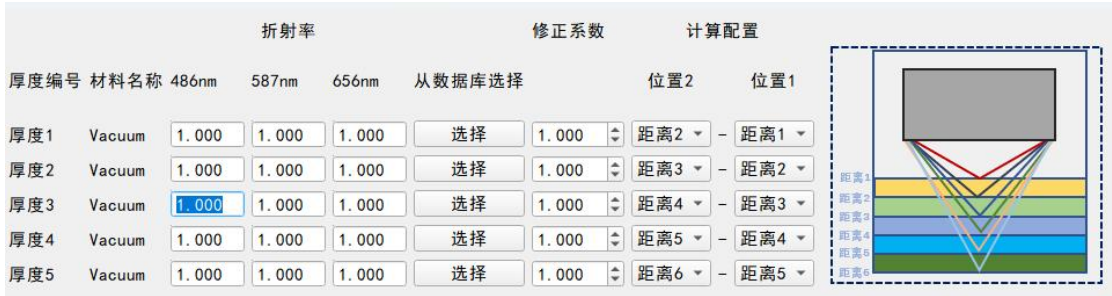
图 5- 19 多层测厚下折射率选择、厚度修正、计算来源配置
