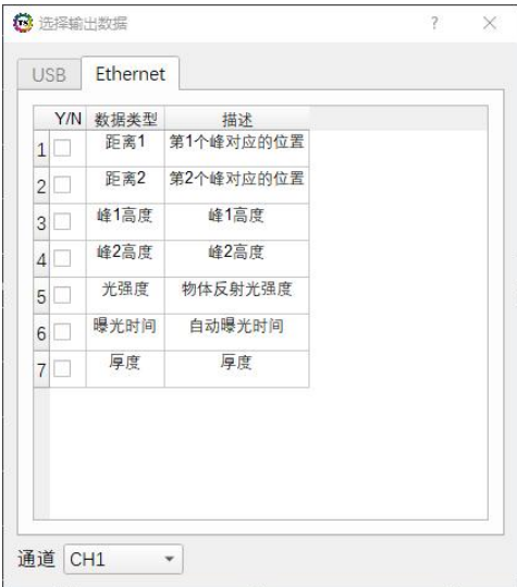
图 5- 31 探头相关输出数据
