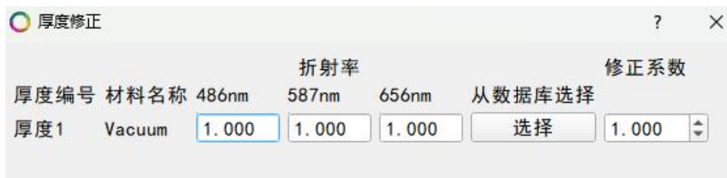
图 5- 18 单层测厚模式下折射率与修正系数
